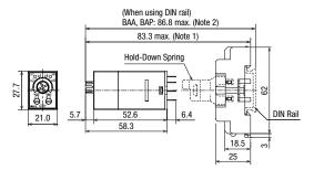
Note 1: SY4S-05B: 83.3 max., SY4S-05C: 83.3 max., SY4S-05D: 88.3 max.,SY4S-05DF: 88.3 max. Note 2: SY4S-05B: 86.8 max., SY4S-05C: 86.8 max., SY4S-05D: 91.8 max.,SY4S-05DF: 91.8 max.
