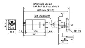
Note 3: SM2S-05B: 83.3 max., SM2S-05C: 83.3 max., SM2S-05D: 88.3 max.,SM2S-05DF: 88.3 max. Note 4: SM2S-05B: 86.8 max., SM2S-05C: 86.8 max., SM2S-05D: 91.8 max.,SY4S-05DF: 91.8 max.
